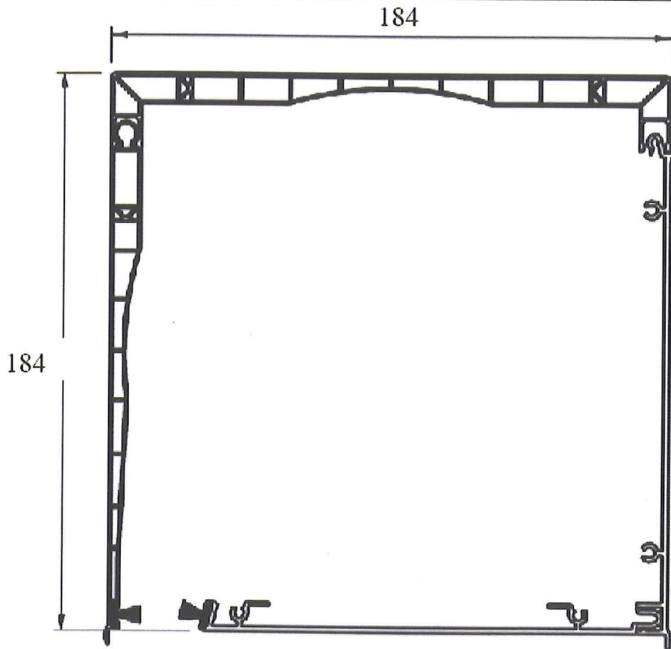
**SECCION DEL CAJON DE PVC “DOS TAPAS DE EXTRUSION”**
