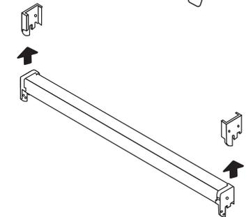
**4** Cortar la guía a la medida del alto del vano, restándole 5cm (altura del cabezal) e instalar en la parte inferior de la guía los sistemas de fijación de la tela mosquitera
